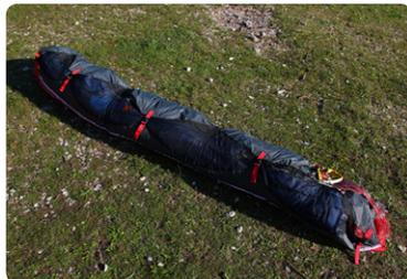
図9. コンチェルトパックを横向きにし、リーディングエッジ補強プラスチックのすぐ後ろでプラスチックを折り曲げないように注意しながら一折し、その後三つ折りあるいは四つ折りにします。
