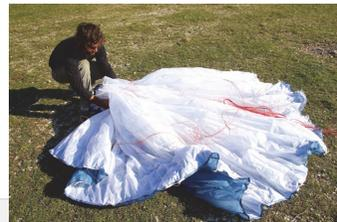
図3. ひとまとめになったリーディングエッジをパッキングベルトで固定します。グライダーをセンター部分で半分に折り重ねずに、翼端から翼端まですっかり蛇腹折りにします。真中のセルを無理に引っ張ったりプラスチックワイヤーを变形させたりしないように慎重に行ってください。
