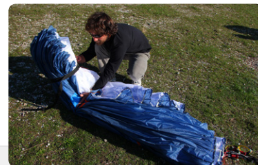
図6. リーディングエッジを折り曲げないようにグラ イダーを三つ折りあるいは四つ折りとします。
