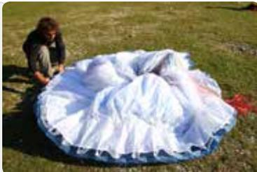
**図2.** Aライン取り付けタブを持って、プラスチックパイプが隣り合わせに重なるようにリーディングエッジ部分をひとまとめにします。
