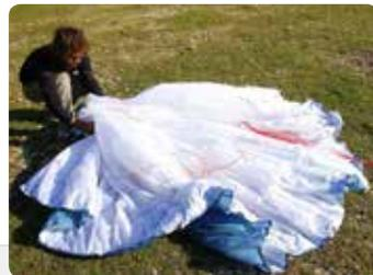
**図3.** ひとまとめになったリーディングエッジをパッキングベルトで固定します。グライダーをセンター部分で半分に折り重ねずに、翼端から翼端まですっかり蛇腹折りにします。真中のセルを無理に引っ張ったりプラスチックパイプを变形させたりしないように慎重に行ってください。
