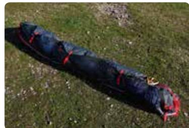
図9. ウィンナーバッグを横向きにしリーディングエッジの補強プラスチックのすぐ後ろでプラスチックを折り曲げない様に注意しながら一折し、その後三つ折りあるいは四つ折りにします。
