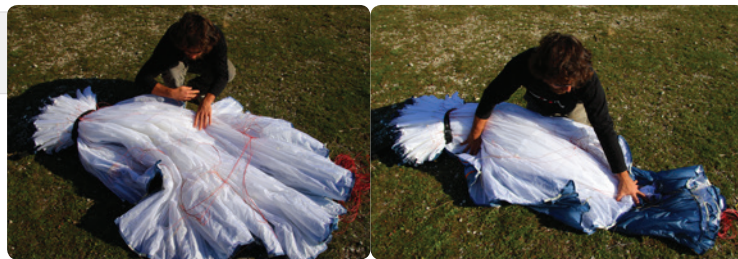
図5. リーディングエッジからトレーリングエッジま でが整頓されたら、グライダーを横向きにします。
