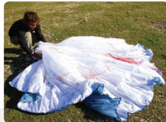
図3. ひとまとめになったリーディングエッジをパッキングベルトで固定します。グライダーをセンター部分で半分に折り重ねず、翼端から翼端まですっかり蛇腹折りにします。真中のセルを無理に引っ張ったりプラスチックロッドを変形させたりしないように慎重に行ってください。
