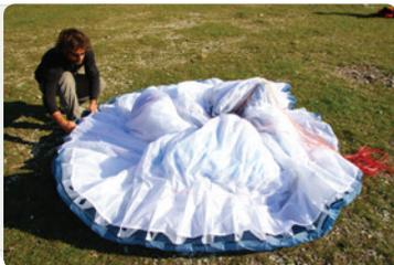
図2. Aライン取り付けタブを持って、プラスチックロッドが隣り合わせに重なるようにリーディングエッジ部分をひとまとめにします。
