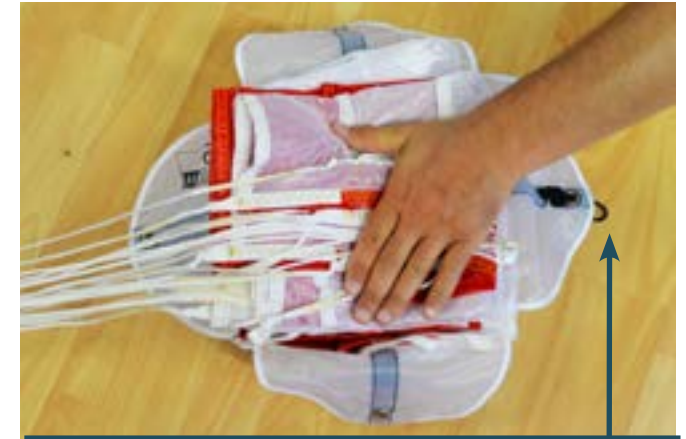
インナーのゴムループがサスペンションラインの反対側に来るようにします。
