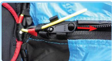
3番目のケーブルはハーネスのブライダル方向に刺し込みます。最初の2つのループを通したら、ファスナーを少し閉じて、残りのループに刺し通します。
