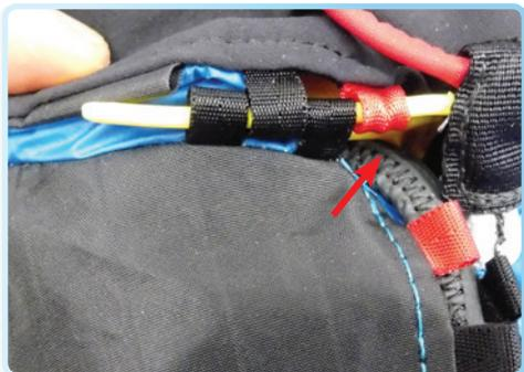
次に、3つの黄色のケーブルをそれぞれのループに通します。まず初めにハーネスの後ろに向かって刺し通すケーブルからスタートします。それぞれのケーブルは正しい順序(最初に赤色のループ)でループに通さなければなりません。赤いループと3つの黒いループを刺し通したらケーブルを最後の保護ループに刺し込みます。
