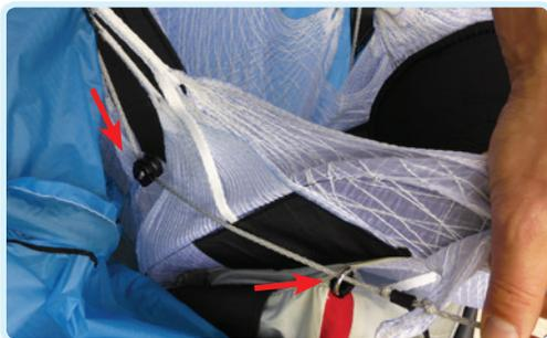
ラインをロンスタンプーリーに通してから、プーリーがねじれていないことを確認しながらリングに通します。ラインがプーリーをきれいに通り、構造部材となっている全てのテープの**内側**を通るようにします。アクセルバーにラインを取り付ける前に、ラインが構造部材となっているテープのいずれにも誤って巻き付いていないことを再確認してください。次に、アクセルバーをフットプレートに取り付けられたバンジー結合します。
