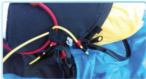
同じ様にハーネスの前側に向かって通すケーブルを刺し込みます。最初の2つのループを通したら、ファスナーを少し閉じて、残りのループを簡単に通るようにします。
