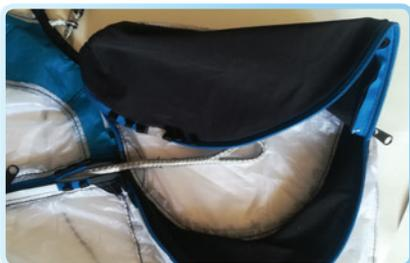
写真のように、ハーネス側のブライダルがレスキューコンテナまで正しく導かれていることを確認します。
