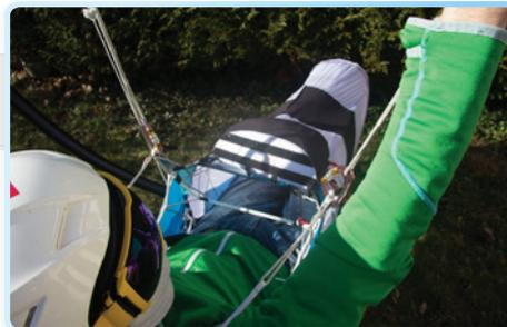
ハーネスを装着するには、まず肩ベルトを肩にかけます。レッグベルトは左右色分けされたTロックバックルで固定されます。Tロックバックルをループにすっきり通し、ゴムバンドでしっかりと固定します。
