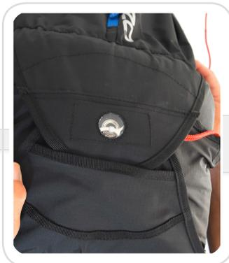
クローズループにピンを差し込みガイドロープをゆっくりと引き抜きます。ガイドロープを引き抜くことを決して忘れないように。パラシュートが引き出せなくなる危険性があります。
