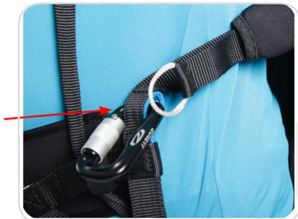
メインハングポイントに取り付けられたカラビナにライザーを接続します。Aライザーが外側に向くように注意してください。
