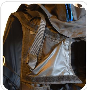
ハーネスのレスキューブライダルはハーネス肩口の接続箇所に内蔵されています。肩ベルトの上部にあるベルクロを開放し、ブライダルを解きます。両方のブライダルをレスキューバッグを引き出す側のベルクロで接着された保護用スリーブ内に納めます。
