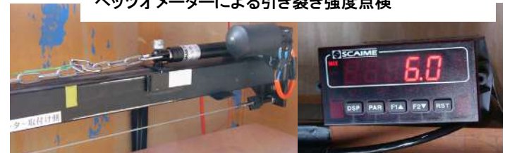
ライン破断試験機による点検の様子
