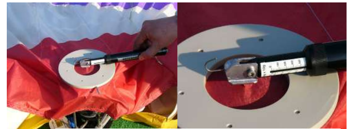
ペッツオメーターによる引き裂き強度点検
