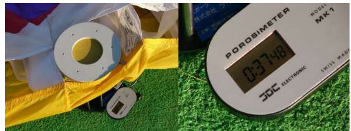
ポロジメーターによるエア漏れ試験の様子
